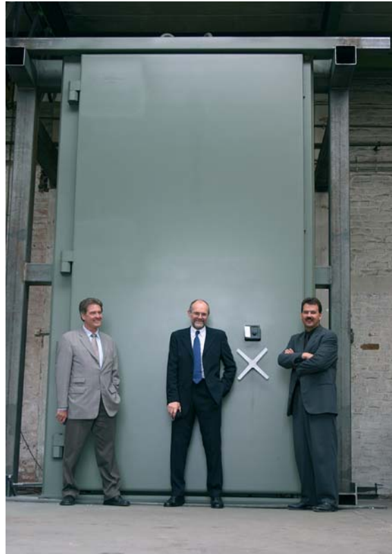
Die Tresortür 4,40 m hoch, in der Werksendmontage vor Auslieferung
